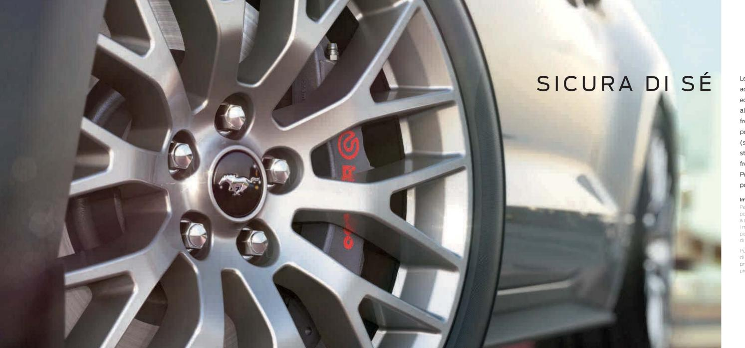
Le auto ad alte prestazioni richiedono freni ad alte prestazioni e Ford Mustang non fa eccezione. Progettata pensando soprattutto alla sicurezza e al controllo, monta pinze freni a quattro pistoni e dischi ventilati posteriori e anteriori. Il potente ABS (sistema frenante antibloccaggio) assicura stabilità, mentre l'EBA (assistenza alla frenata di emergenza) e l'Electronic Brake Prefill contribuiscono a offrire la migliore potenza di frenata possibile.
